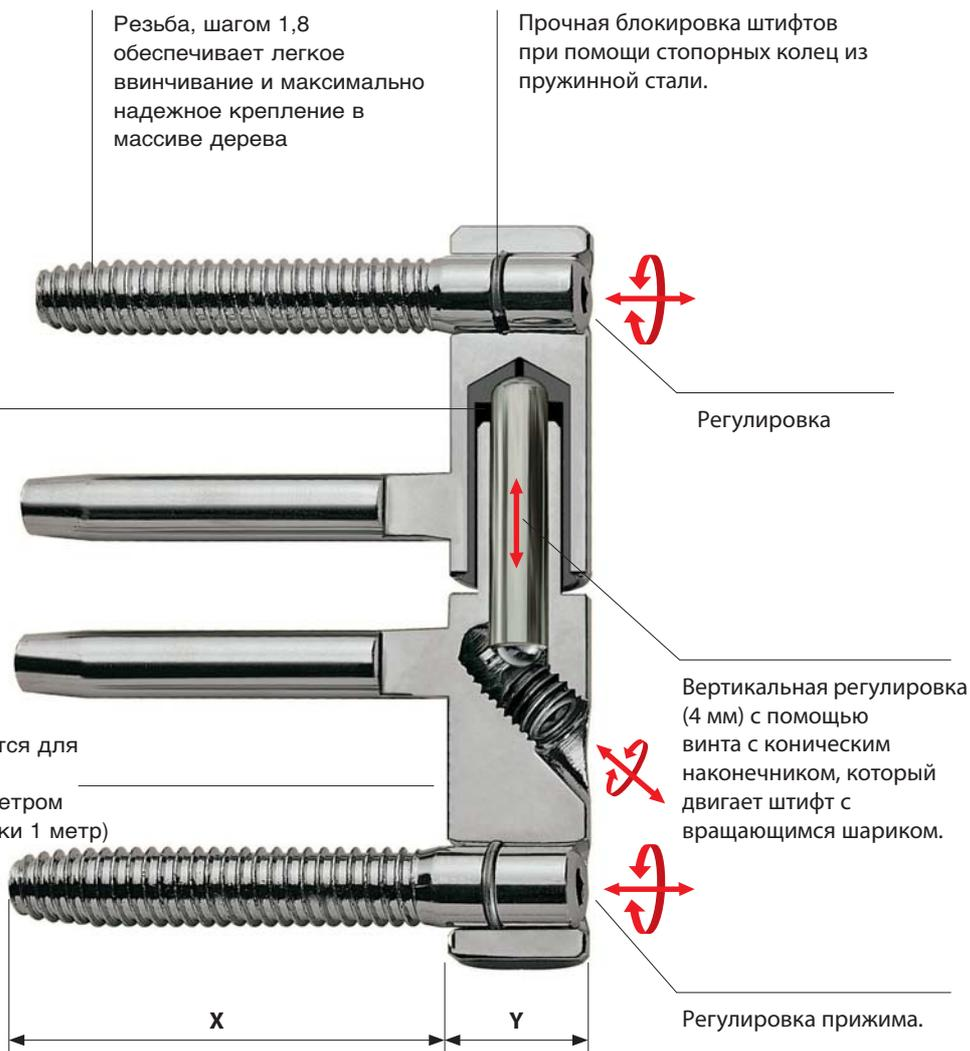
Внутренний паз петли с долговечной автосмазывающейся пластиковой втулкой обеспечит плавную работу
